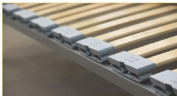
Летто де Люкс – Латодержатели-амортизаторы, изготовленные из стойкого к нагрузкам каучука, имеющие две степени свободы, благодаря чему каждая ламель работает в двух плоскостях, создавая максимальный комфорт для сна.
