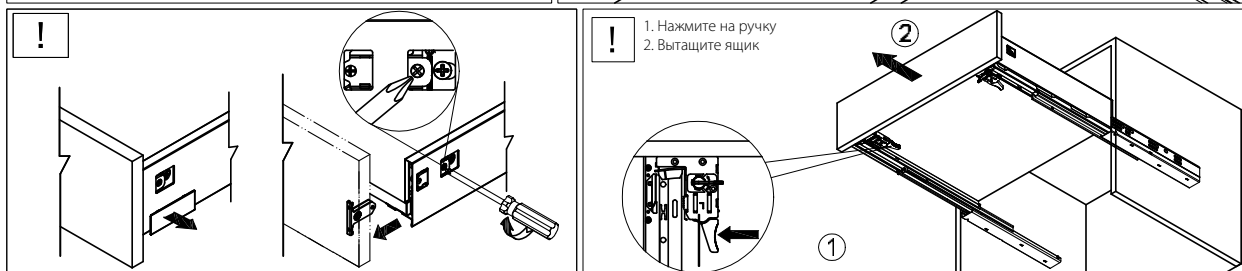
Установка и регулировка металлического рейлинга
