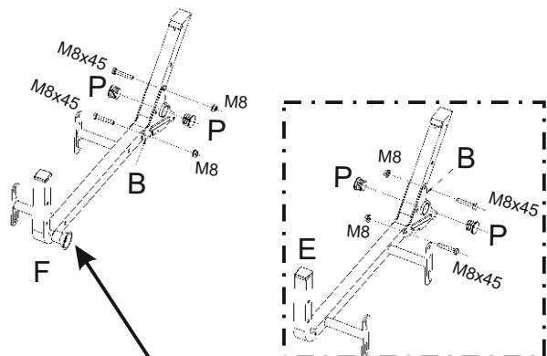
Внимание! Для типоразмера 70, 120 детали Е и F устанавливаются стопорными роликами наружу.
