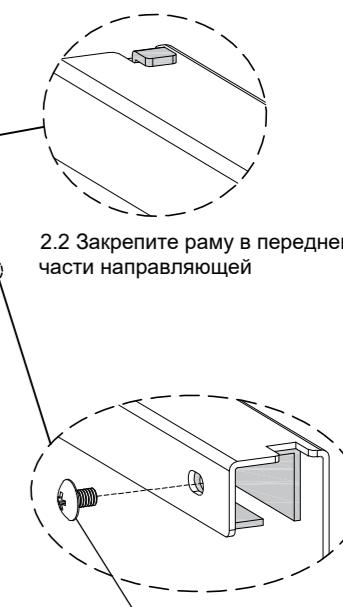
2.2 Закрепите раму в передней части направляющей
