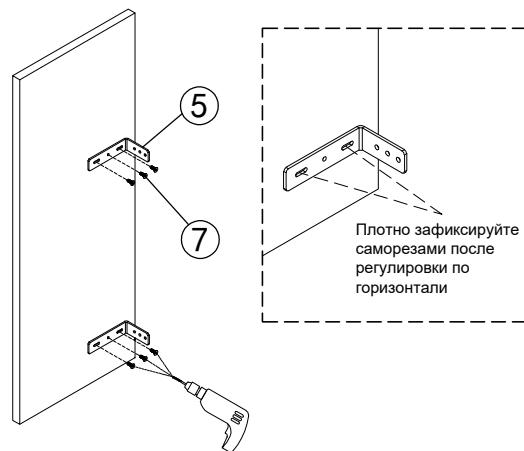
3.3 Установите фасад на раму и зафиксируйте винтами
