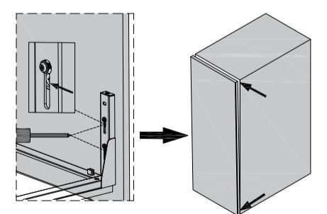
5.4 Зафиксируйте после регулировки
