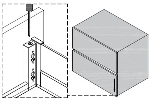
4.3 Регулировка по глубине
