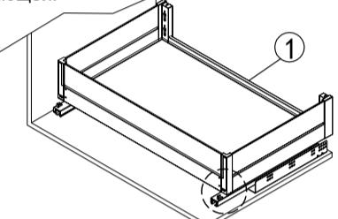
2.2 Задвиньте корзину до упора. Щелчок при задвигании корзины указывает на то, что направляющие зафиксированы в креплениях Clip On. Установка завершена.
