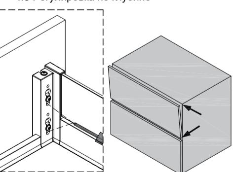
4.4 Зафиксируйте после регулировки
