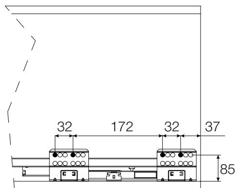
Зафиксируйте направляющие **B** на боковине при помощи саморезов **G**
