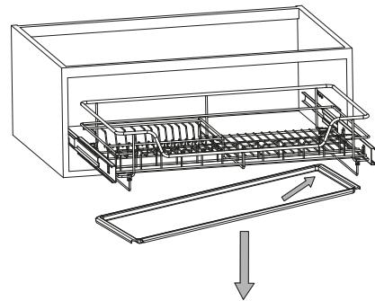
Установите фасад на корзину используя крепление **F** и саморезы **G**
