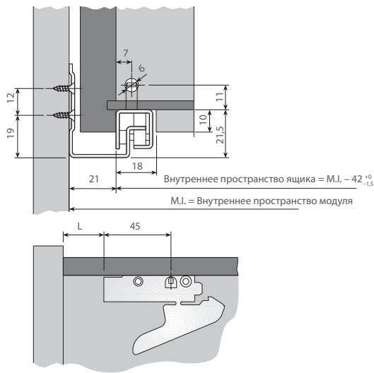
Схема сборки и регулировки при монтаже Clip-on
