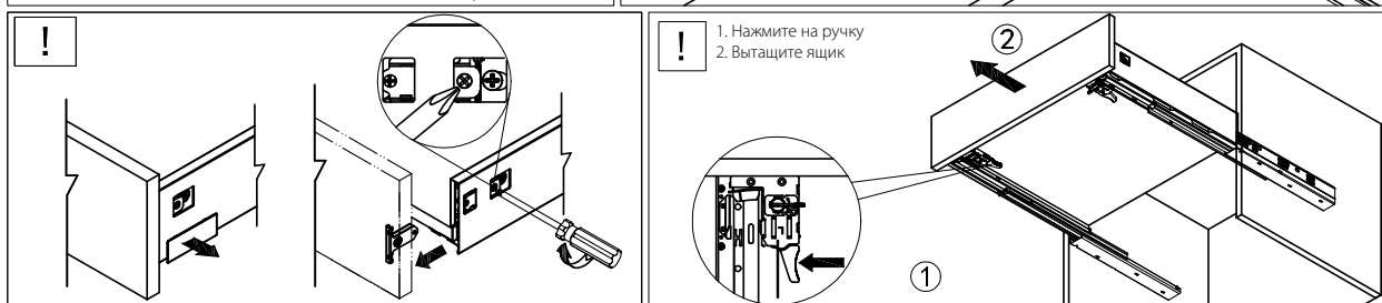
Установка и регулировка металлического рейлинга
